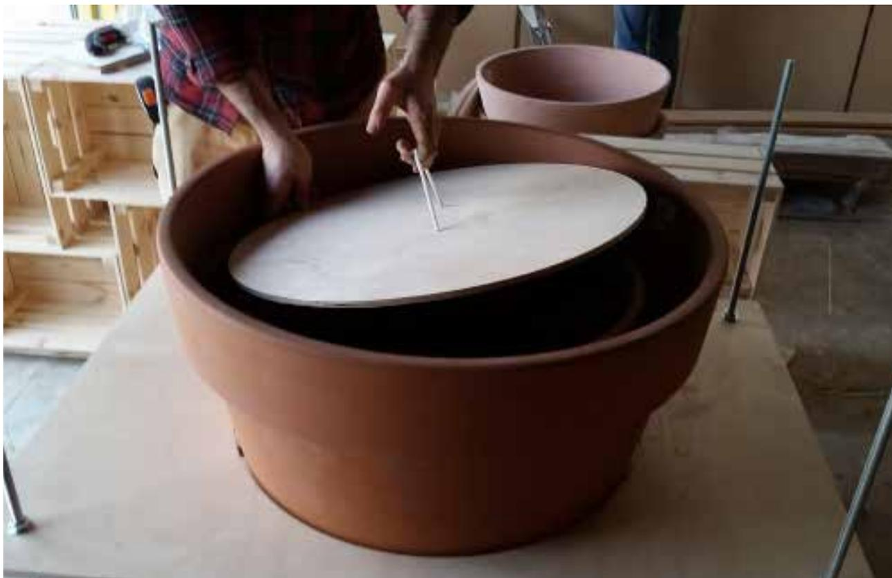
Un cran a été effectué à la défonceuse afin de stabilier le couvercle :
